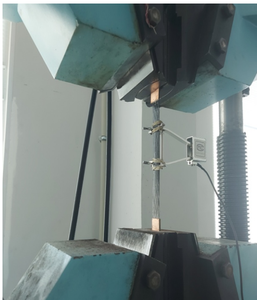
Рисунок 3. Испытание композитных ламелей на осевое растяжение
